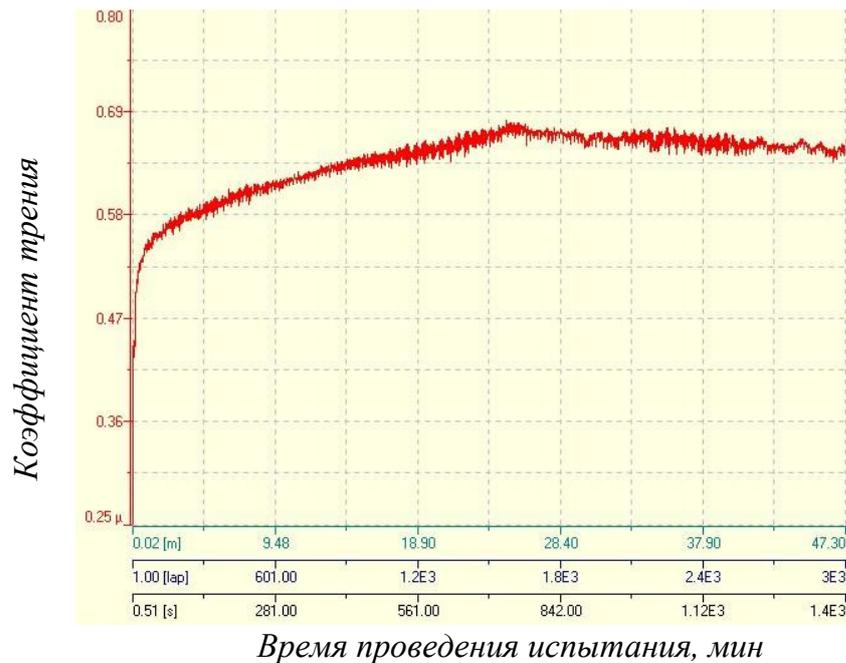
Рисунок 54 – Определение коэффициента трения образца, спеченного при температуре 1200 °С
