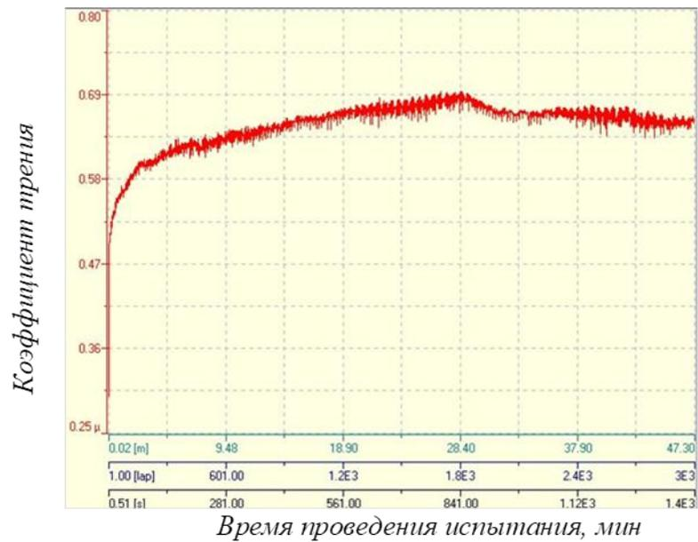
Рисунок 57 – Определение коэффициента трения образца спеченного при температуре 1300 °С
