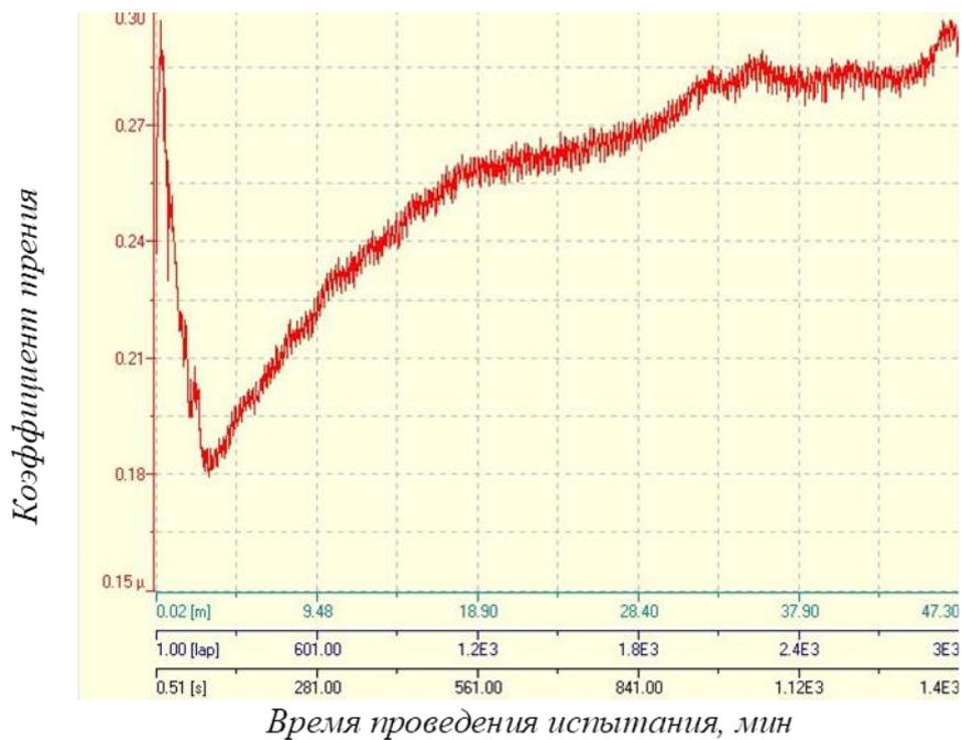
Рисунок 63 – Определение коэффициента трения образца спеченного при температуре 1500 °С
