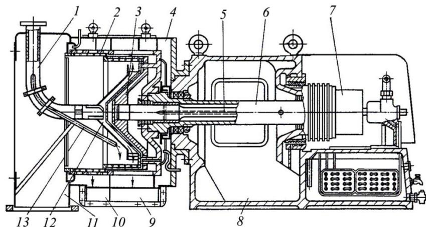
1 – питающая труба; 2 – ротор; 3 – толкатель; 4 – кожух; 5 – вал; 6 – полый вал; 7 – гидроцилиндр; 8 – станина; 9 – приемник фильтрата; 10 – сборник промывной жидкости; 11 – приемник осадка; 12 – распределительный конус; 13 – труба для промывной жидкости.
