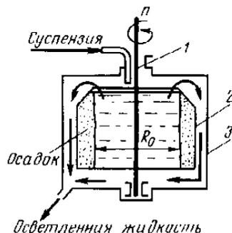
1 – ротор (ось вращения); 2 – вращающийся барабан; 3 – неподвижный кожух (корпус) центрифуги.
