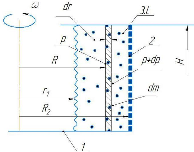
1- барабан; 2 - фильтрующая перегородка; 3- шквара.
