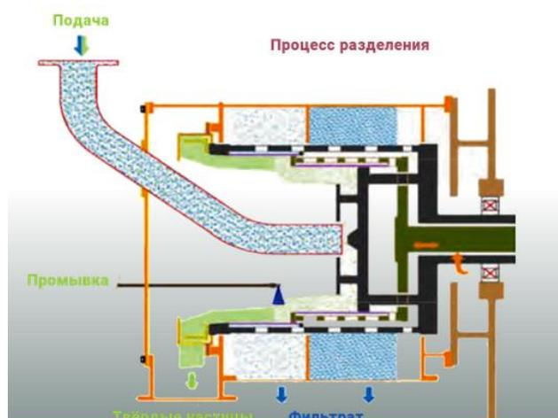
Рисунок 1.11 - Схема технологического процесса в центрифуге LLW
