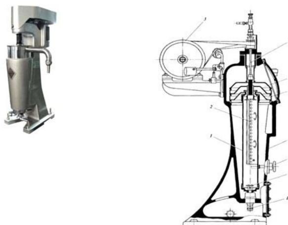
1 – ротор; 2 – крыльчатка; 3 – электродвигатель; 4 – вал; 5 – верхняя сливная тарелка; 6 – нижняя сливная тарелка; 7 – станина; 8 – тормоз; 9 – отбойный диск; 10 – питающая труба.
