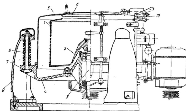
1 - ротор перфорированный; 2 - опорный конус; 3 – вал; 4- дно станины; 5 - кожух неподвижный; 6 - крышка кожуха; 7 - станина. 8 – тяга; 9- колонка; 10 - ручной тормоз.
