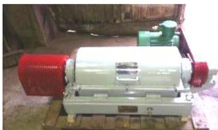
Рисунок 1.8 - Центрифуга серии ОГШ - ОГШ-202К-03
