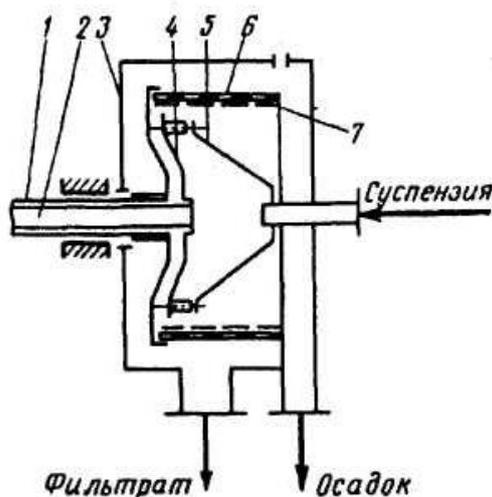
1 - полый вал; 2- шток; 3- корпус; 4 -поршень-толкатель пульсирующего действия; 5 - приёмный конус; 6- барабан; 7- сито.
