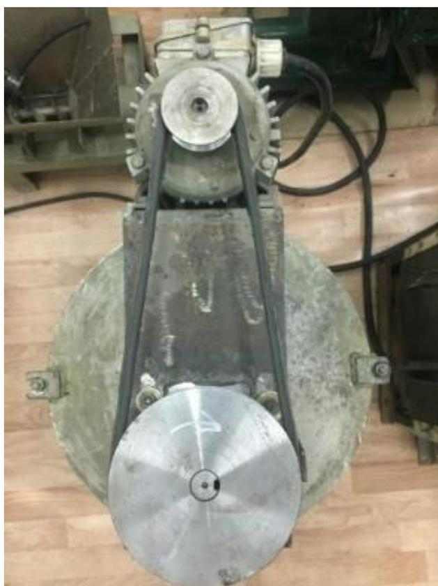
Рисунок И.4 - Привод шнека подачи
