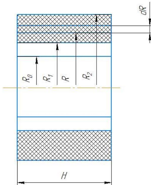
Рисунок 1.3 - К выводу уравнения центробежного фильтрования.
