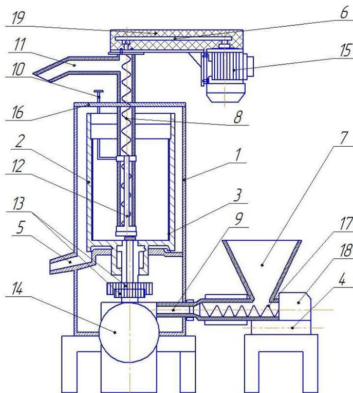
1-корпус; 2-фильтрующий барабан;3-сетка; 4-питатель; 5-патрубок; 6- клиноремная передача; 7- бункер; 8-шнек разгрузочного устройства; 9- трубопровод; 10- рычаг; 11-патрубок разгрузочный; 12-скребок; 13-шестеренчатая передача; 14-двигатель центрифуги; 15- двигатель разгрузочного устройства; 16- крышка центрифуги; 17-шнек разгрузочного устройства;18- двигатель питателя; 19- защитное ограждение клиноремной передачи.
