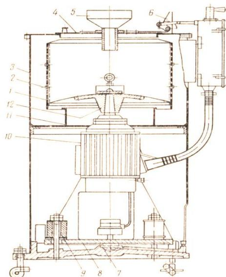
1 – ротор; 2 – банжаж; 3 – кожух; 4 – крышка; 5 – воронка; 6 – блокирующее устройство; 7 – шаровая опора; 8 – основание; 9 – амортизатор; 10 – электродвигатель; 11 – воротник; 12 – ступица.
