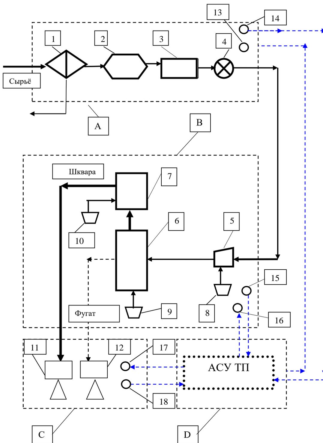
Рисунок 5.2 - Схема производства шквары из жирового сырья
