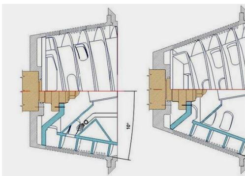
Рисунок 1.13 - Схема углов наклона конуса барабана ротора центрифуги
