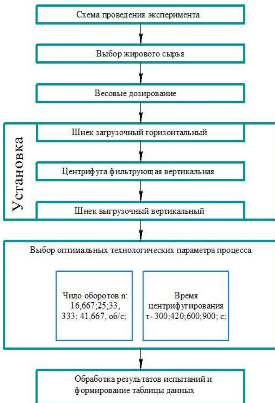
Рисунок 2.2 - Блок-схема эксперимента
