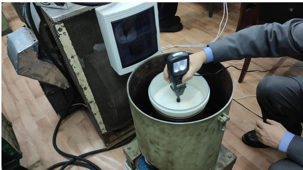
Рисунок И.7 - Ход эксперимента, снятие показаний цифровым тахометром:
