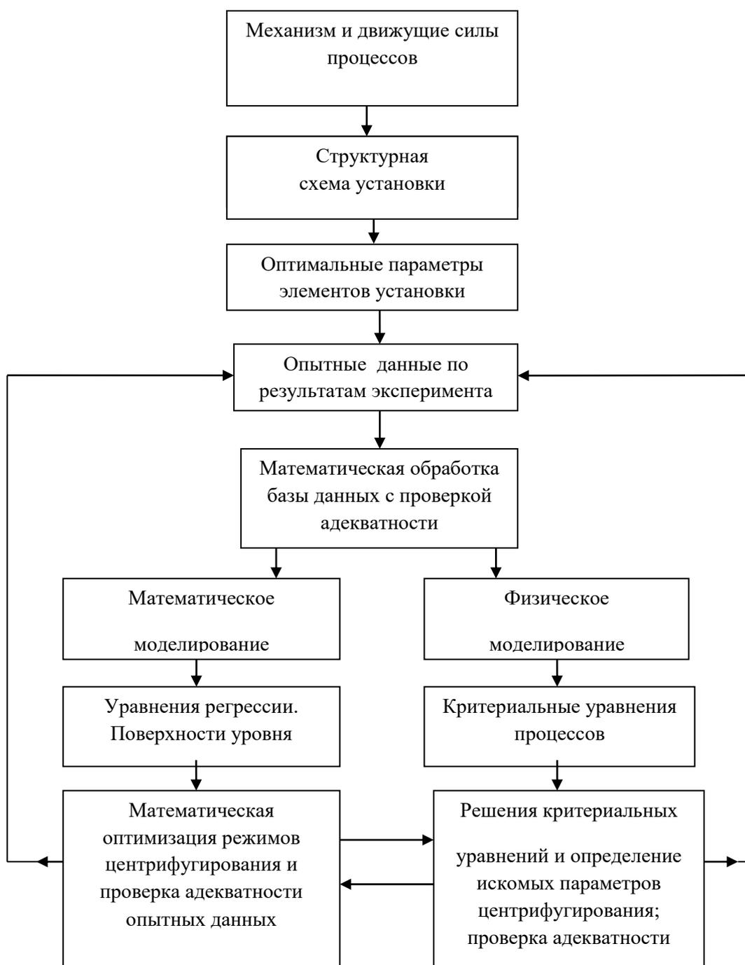
Рисунок 2.3 - Блок-схема физико-математического моделирования
