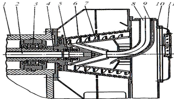
1 – корпус подшипниковой опоры; 2 - вал шнека; 3 – подшипник; 4 – вал ротора; 5 - подшипник; 6 – ротор; 7– витки шнека; 8 – питающая труба; 9 – труба для подачи промывной жидкости; 10 – кожух; 11 - смотровое стекло.
