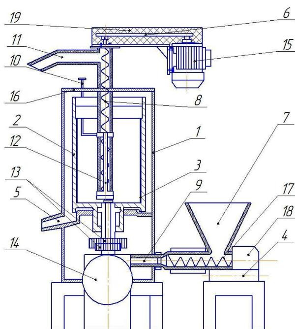
1-корпус; 2-фильтрующий барабан; 3-сетка; 4-питатель; 5-патрубок; 6- клиноременная передача; 7- бункер; 8-шнек разгрузочного устройства; 9- трубопровод; 10 - рычаг; 11-патрубок разгрузочный; 12-скребок; 13-шестеренчатая передача; 14-двигатель центрифуги; 15-двигатель разгрузочного устройства; 16- крышка центрифуги; 17-шнек разгрузочного устройства; 18-двигатель питателя; 19- защитное ограждение клиноременной передачи.
