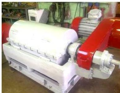
Рисунок 1.9 - Центрифуга серии ОГШ - ОГШ-352К-03
