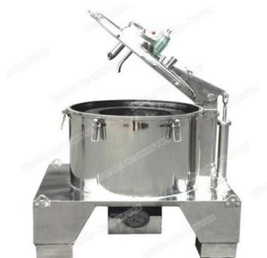
Рисунок 1.18 - Вертикальная центрифуга PBZ с верхней выгрузкой
