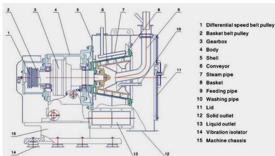
Рисунок 1.12 - Схема горизонтальной шнековой центрифуги LLW
