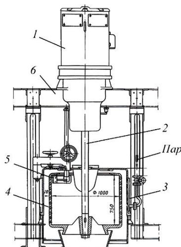
1 – электродвигатель; 2 – вал; 3 – рубашка; 4 – ротор; 5 – нож; 6 – рама.
