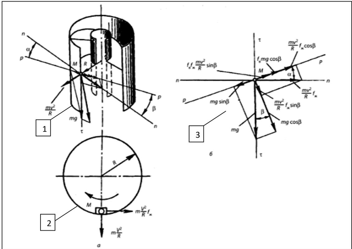
Рисунок 5.4 - Схема сил, действующих в вертикальном выгрузочном шнеке
