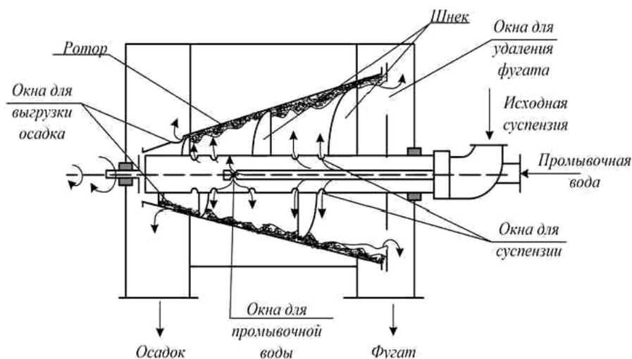
Рисунок 1.22 - Отстойно-осадительная шнековая центрифуга непрерывного действия
