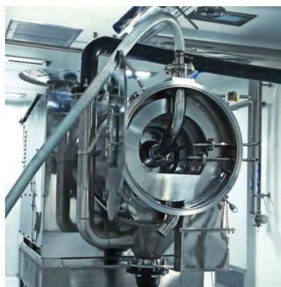
Рисунок 1.14 - Внешний вид типичной центрифуги серии LLW
