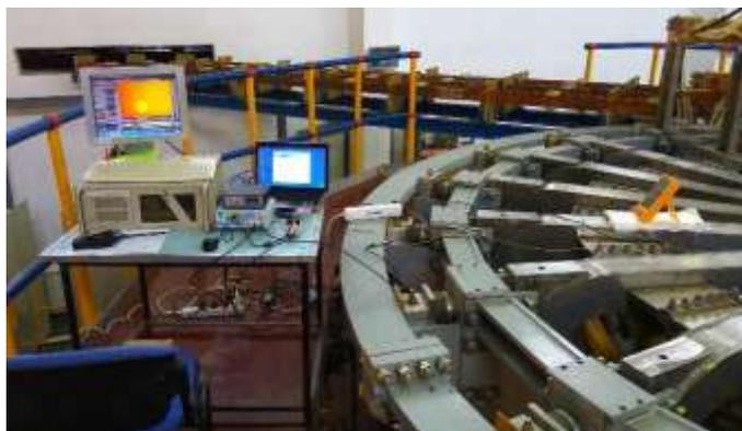
Рисунок 76 – Размещение измерительного оборудования на эстакаде КТМ во время проведения экспериментов
