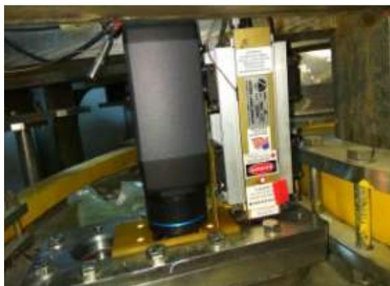
Рисунок 75 – ИК камера с  $\text{CO}_2$  лазером на трековом патрубке КТМ
