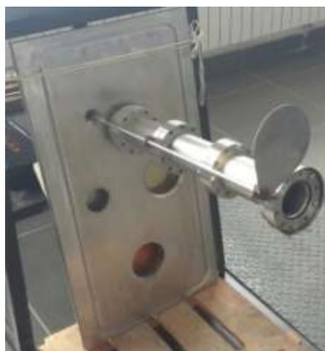
Рисунок 36 – Вакуумный смотровой патрубок системы визуализации плазменного шнура
