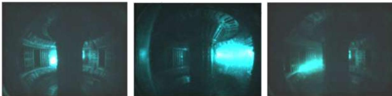
Рисунок 44 – Видеокадры изображения с быстрой камеры системы визуализации плазменного шнура во время работы тлеющего разряда
