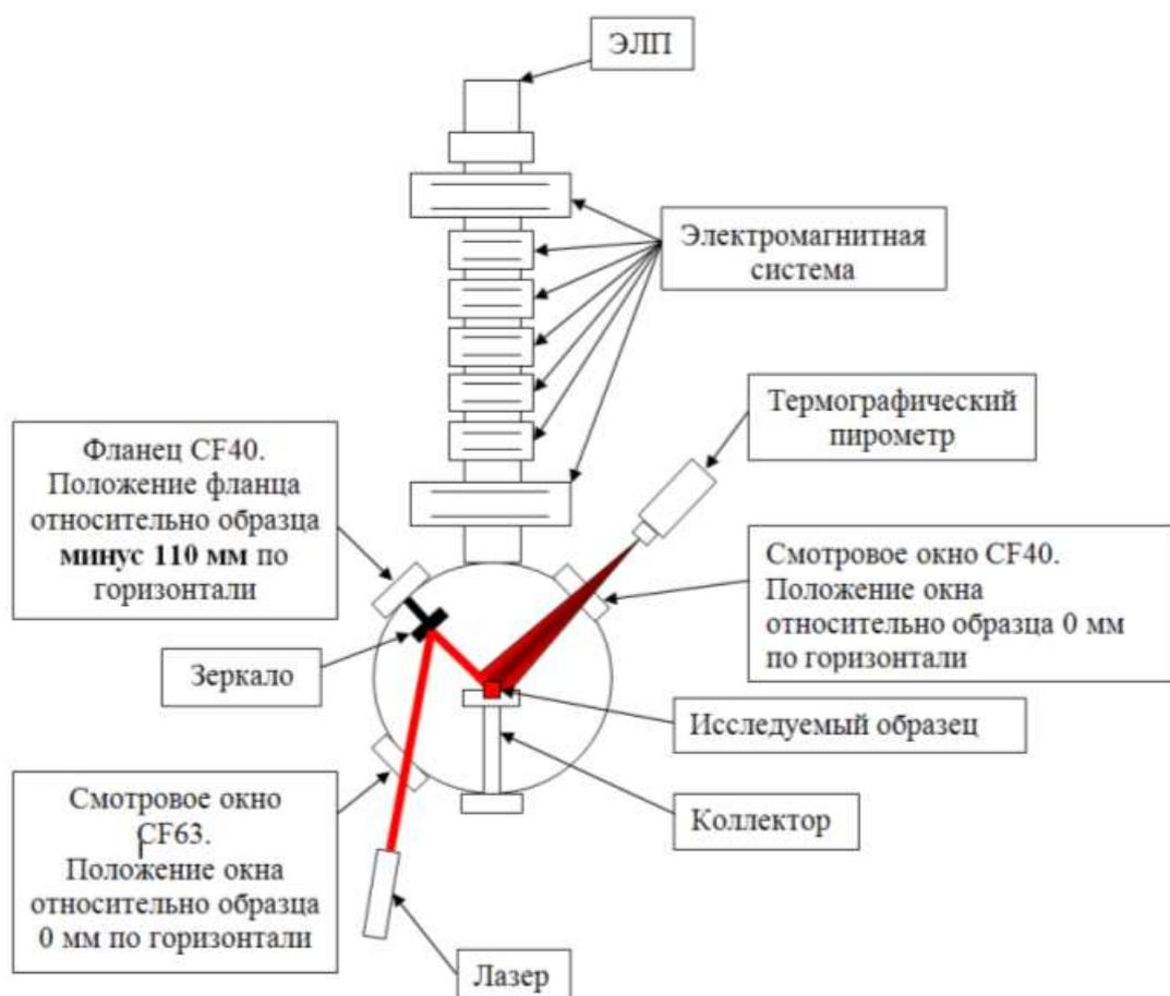
Рисунок 80– Схема термографического измерения на имитационном стенде с плазменно-пучковой установкой
