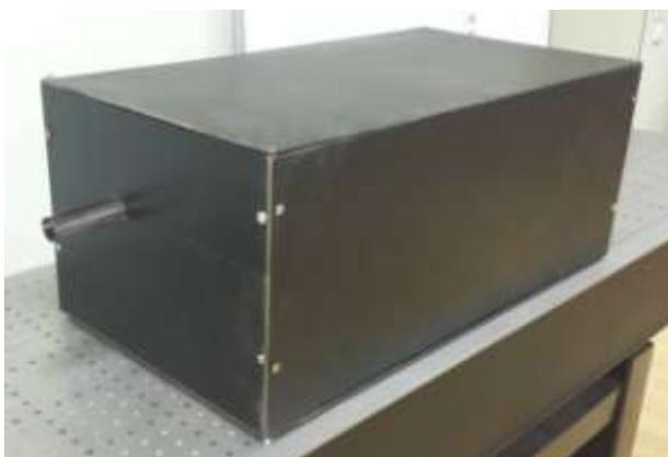
Рисунок 39 – Магнитный экран системы визуализации плазменного шнура
