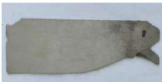
Рисунок 86 – Образец вольфрама после нагрева в ИС ППУ
