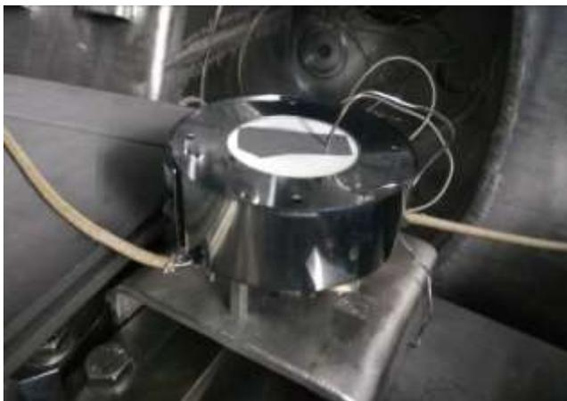
Рисунок 73 – Высокотемпературный нагреватель, установленный внутри ВК КТМ с образцом
