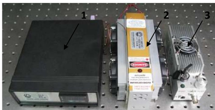
1 – контроллер температуры лазера, 2 – лазер, 3 – ВЧ драйвер
