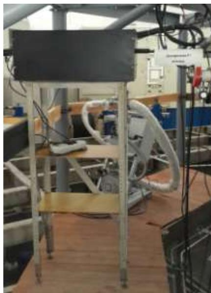
Рисунок 41 – Система визуализации плазменного шнура в экране на оптическом столе на штатном месте
