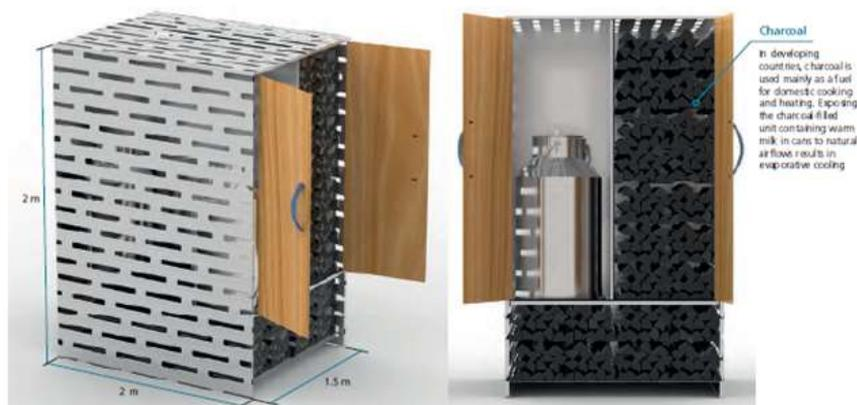
Рисунок 3 - Испарительное охлаждение молока с древесным углем
